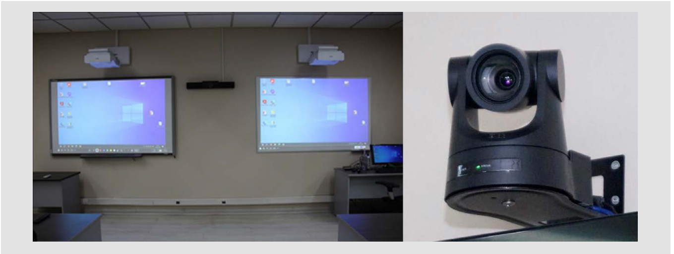
Figura 24: Proyector, pantallas y cámara con IA para seguimiento del docente.
